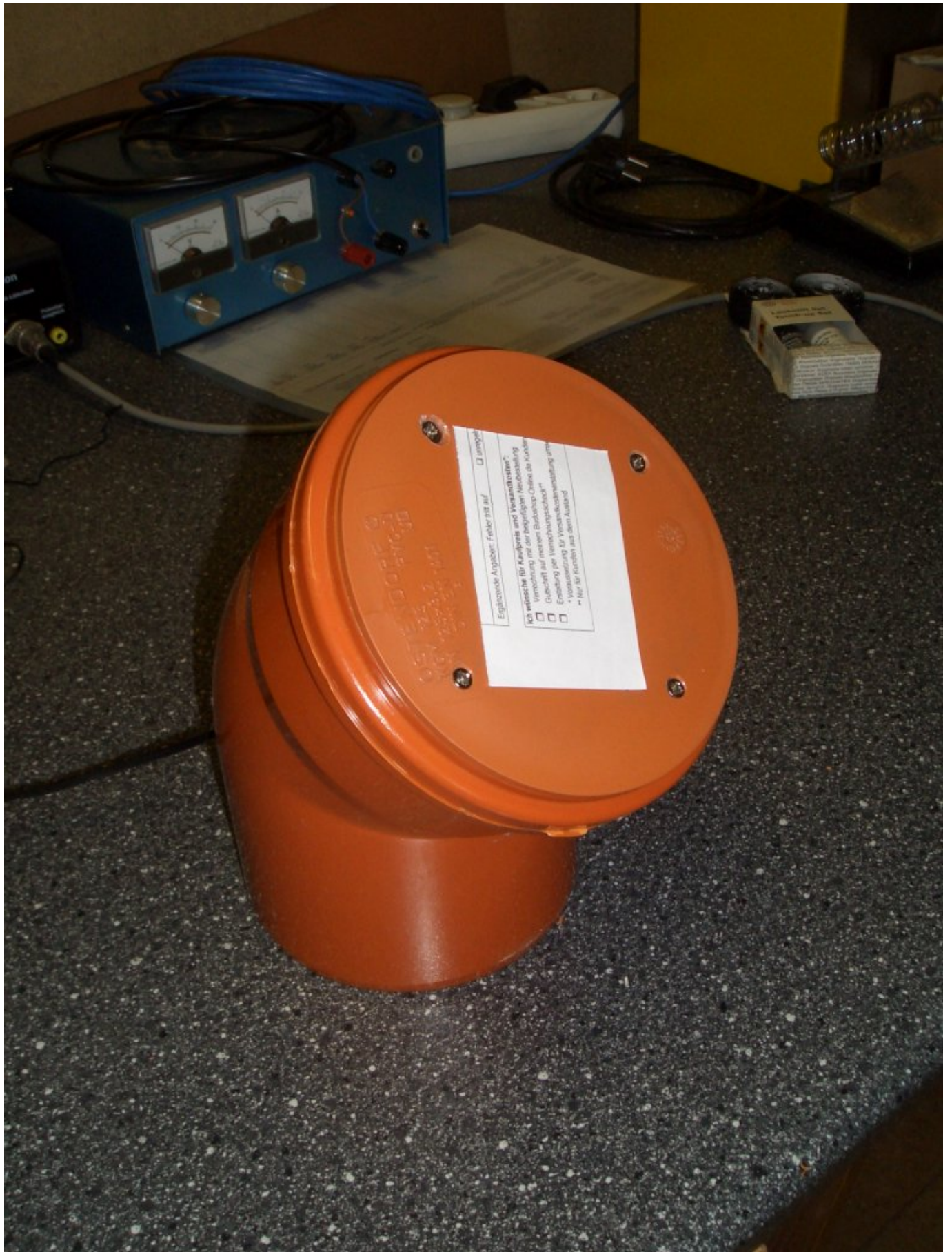
Zusammengeträllert aus Abwasserrohrstücken, einem 80mm PC- Lüfter und
